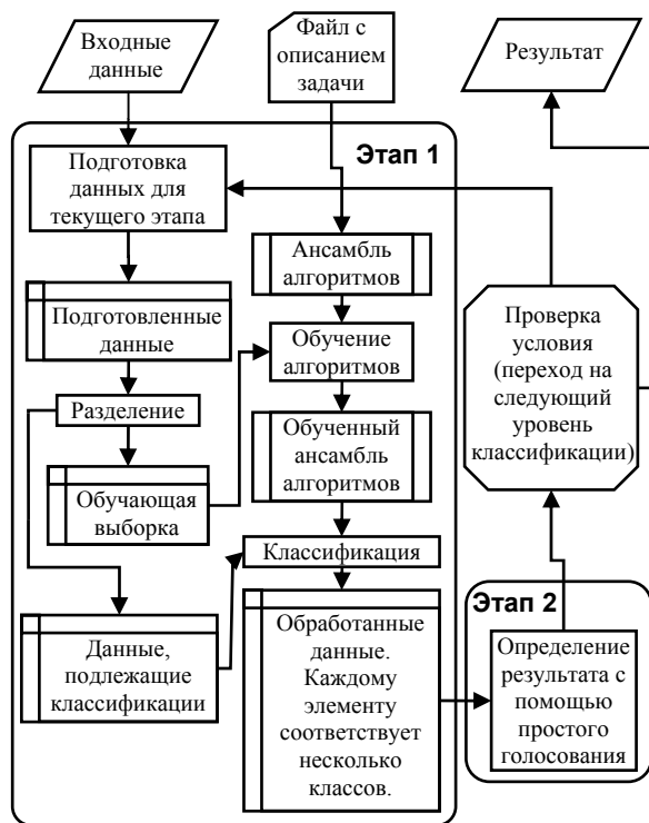
Рис. 3. Схема работы ансамбля классификаторов в задаче о классификации затменных двойных звёзд
